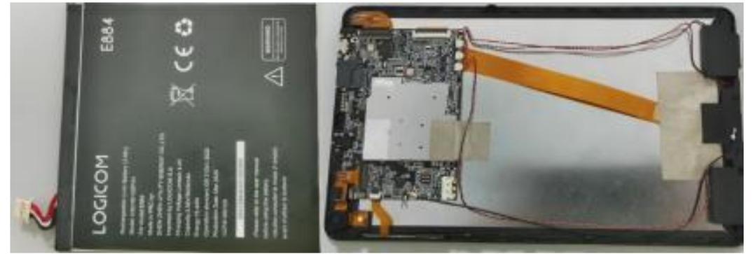
**STEP FOUR: Disconnect the antenna connector, remove 2 pcs of antenna bracket screws, and detach the WiFi antenna/ Débranchez le connecteur d'antenne, retirez les 2 vis du support d'antenne et détachez l'antenne WiFi**
