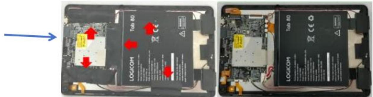
STEP THREE: Disconnect the battery cable and LCD FPC cable, pull the battery adhesive tabs to remove the battery/ ÉTAPE 3 : Déconnecter le câble de la batterie et le câble FPC de l'écran LCD, puis tirer sur les languettes adhésives de la batterie pour la retirer
